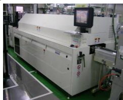
鉛フリーはんだリフローライン
