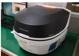
蛍光X線分析装置 島津製作所製 EDX-7000
