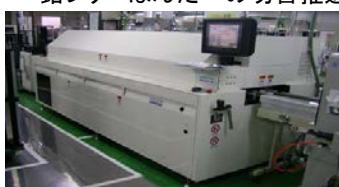
鉛フリーはんだリフローライン
